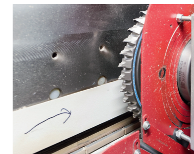
Zerspaner beseitigen das Gros des Materials und entlasten die Fügefräser
