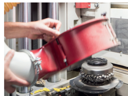
Für das Nachschieben der Schneiden ist die Spanhaube zu lösen
