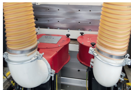
... der zweite und der dritte Fügefräser im Gleichlauf für 16er- oder 19er-Fronten
