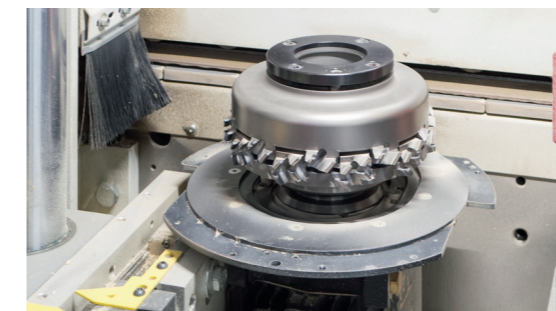
Der Fügefräser liegt frei und lässt sich bequem mit dem Inbusschlüssel von oben verstellen
