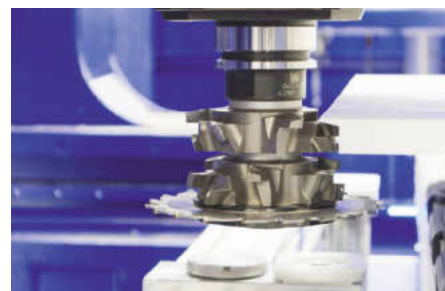
Das Dreifachwerkzeug auf der CNC
