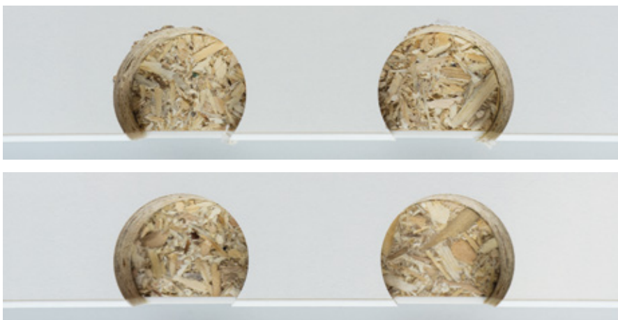
Boven: Het boren van beslaggaten aan de rand met gebruikelijke beslagboren.
